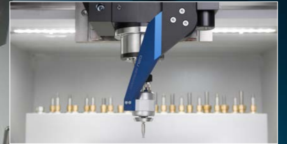
3D Messtaster (XYZ-Sensor) und Kamera
