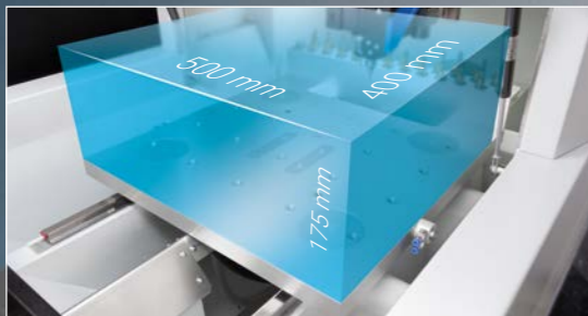
Ergonomischer, frontaler Zugang zum Arbeitsraum
