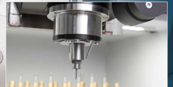
2 kW Spindel und Minimalmengen-Kühlschmiersystem
