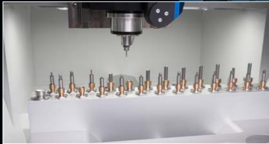
24-fach Werkzeugmagazin mit integriertem Längensensor
