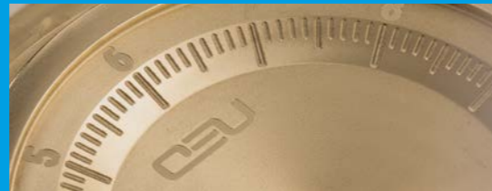
Feinste Gravuren mittels kleiner Werkzeuge
