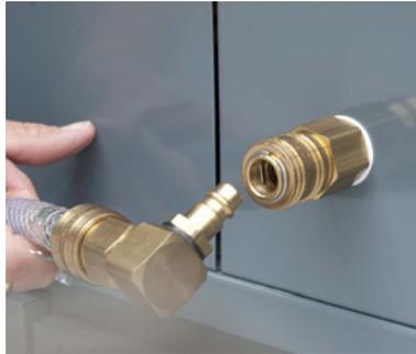
Fig. 2-3 : Branchement air comprimé raccord rapide 1/2"
